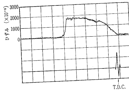
図 18 吐出弁のひずみ波形の一例 吸入圧力 2.0 kg/cm² 吐出圧力 11.8 kg/cm² 掃引時間 1 ms/div
