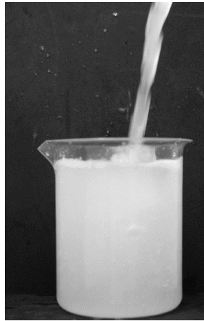
Fig.0-1 氷スラリー（過冷却方式，I P F 10%弱，エチレングリコール水溶液から生成）
