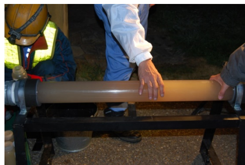
図 4-12 アイスピグ工法による排水管の初期排水(左)と経過後の排水(右)の状態(4-19)
