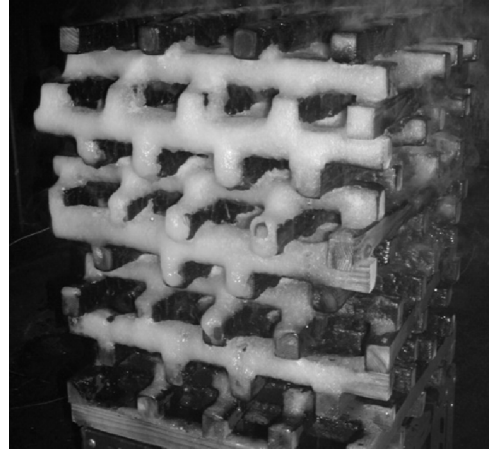
図 4-11 0.5 単位クリブの燃焼実験(左図)と消火後のクリブへの氷粒子層の残留状態(4-17)
