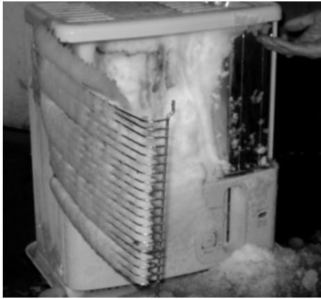
図 3-21 氷粒子が付着したストーブの例(3-25)
