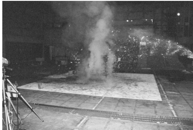
図 3-22 2 単位クリブへの氷粒子による消火実験(3-25)
