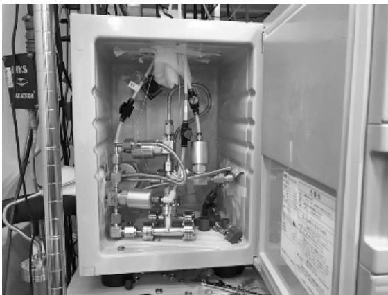
図3 スニッファ法用標準リーク校正システム内部
