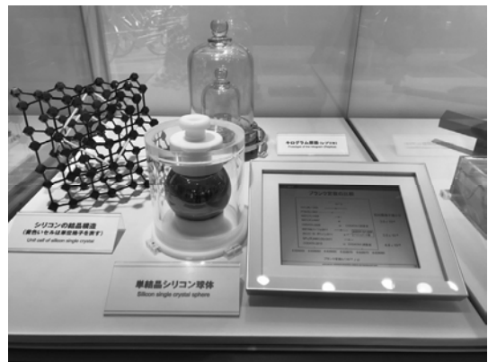
図2 単結晶シリコン球体とキログラム原器
