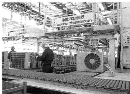
図1 エアコンの冷媒回収ライン
