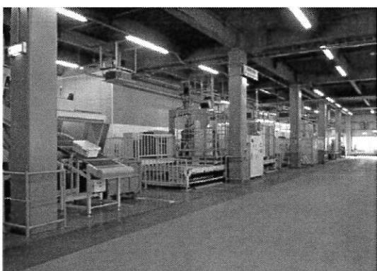
図3 冷蔵庫の手分解ライン
