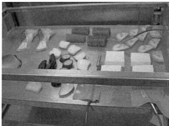
図3 従来型フリーザーに凍結サンプルを並べ、温度センサーをセットした状況。凍結サンプルは高風速トンネルフリーザーと同じ品物で同形状にしてある。
