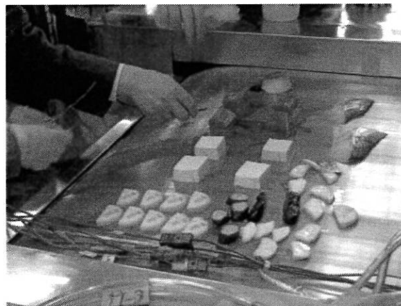
図2 高風速トンネルフリーザーに凍結サンプルを並べ、温度センサーを参加者がセット
