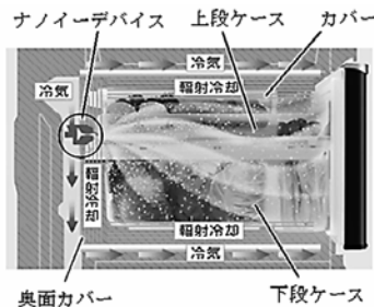
図1 冷蔵庫用ナノイーデバイスおよび野菜室構成
